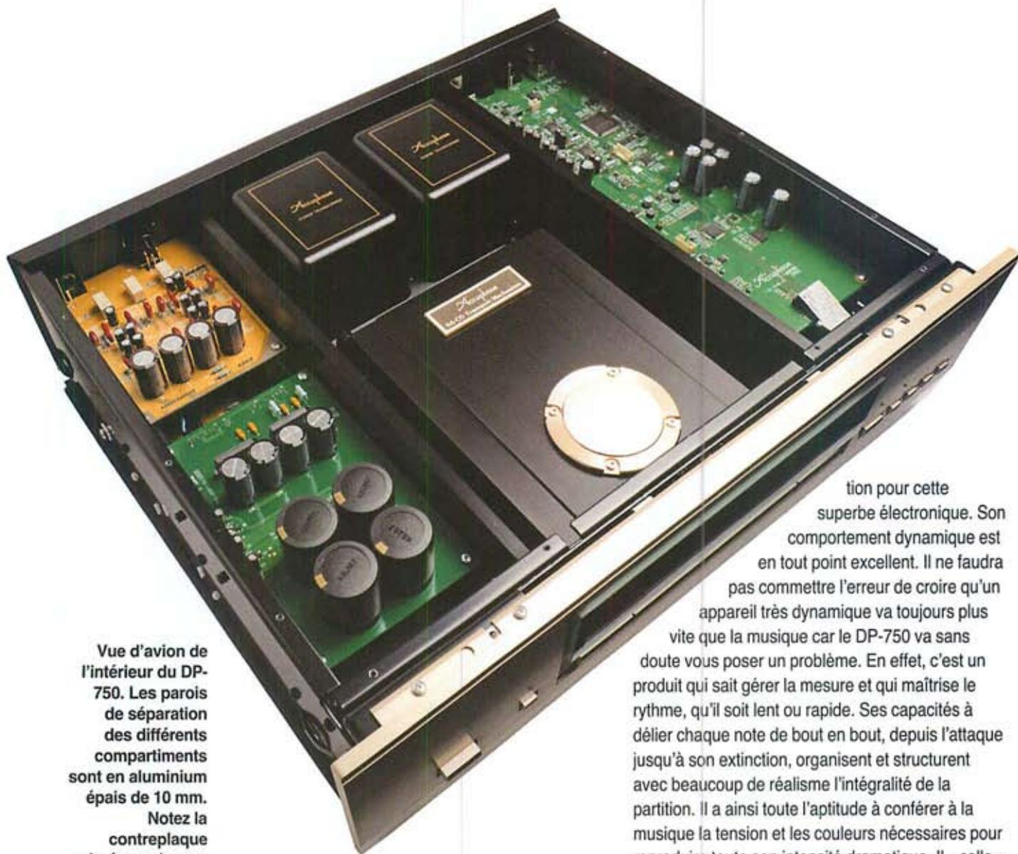
Vue d'avion de l'intérieur du DP-750. Les parois de séparation des différents compartiments sont en aluminium épais de 10 mm. Notez la contreplaque cuivrée au-dessus du transport, qui renforce la référence mécanique du palet presseur.
